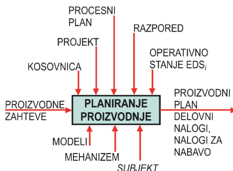
Slika 7.1. Digitalizirana funkcija planiranja proizvodnje v konceptu KFPS [1]
