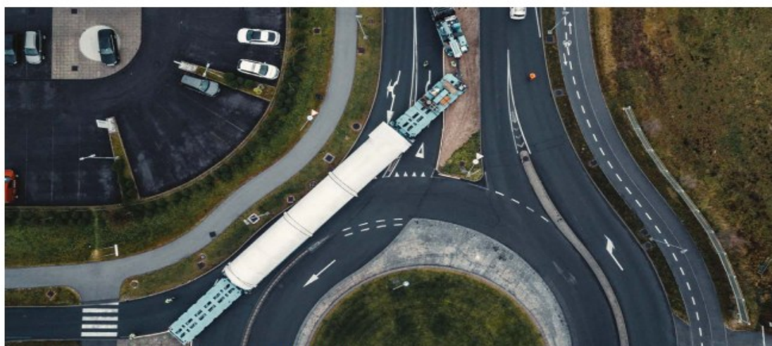
Izredni prevoz izjemnih dimenzij in teže na poti (prikaz premagovanja cestne infrastrukture).
