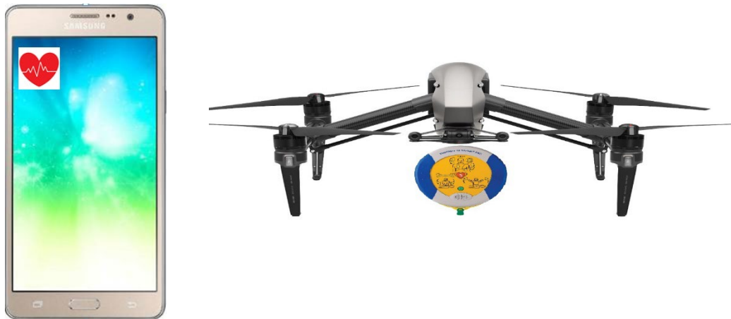
Slika 3: Aplikacija in dron z nameščenim defibrilatorjem
