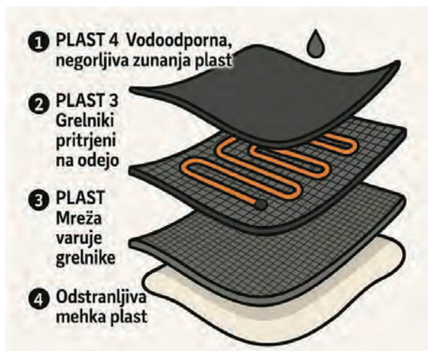
Slika 2: Plasti blaga pri prototipu odeje Fire horse
