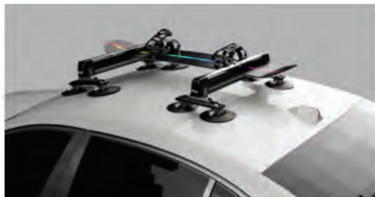
Slika 2: Sistem pritrdjevanja – vakuum ali na strešne nosilce
