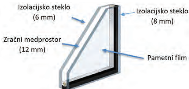
Slika 2: Prikaz dvoslojne zasteklitve sten TihoBoxa
