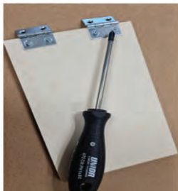
Vijačenje pantov na vratca in privijačenje dna
