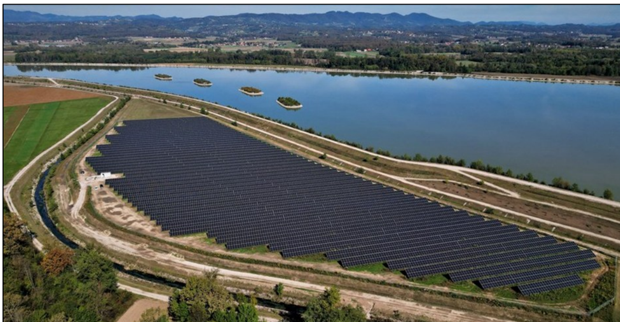
Slika 3: Hibridni sistem HE Brežice – sončna elektrarna 6 MW
