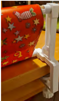
Slika 5: Mehanizem za pritrditev na mizo oziroma likalno desko
