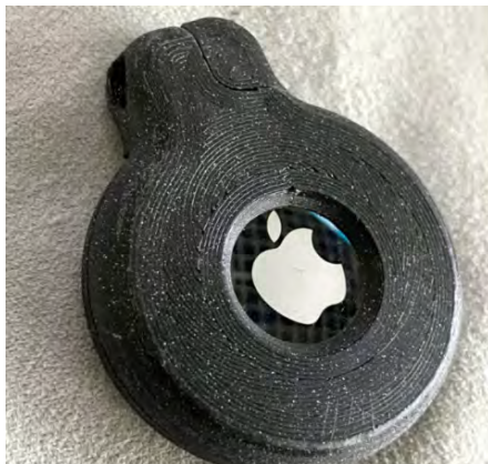
Slika 1: Primer 3D-natisnjenega obeska za AirTag
